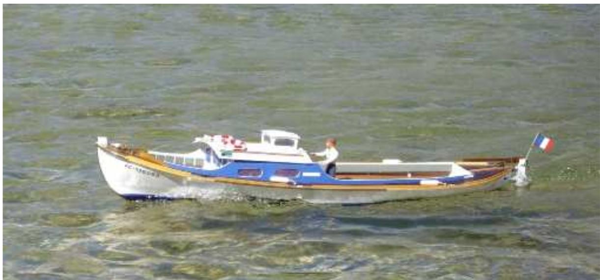
Pinasse modèle navigant tout bois, bordées de 4/5/6 m/m de large sur 3m/m épaisseur. Sur membrures contreplaqué de 5m/m, pont acajou, baguettes de 3X3 .Comme sur l'original système de gouvernail et arbre d'hélice se soulevant pour éviter de trainer dans le sable au retour de marée basse. Radio 2 voies, variateur mécanique. Caisse de transport. TTC 500€
