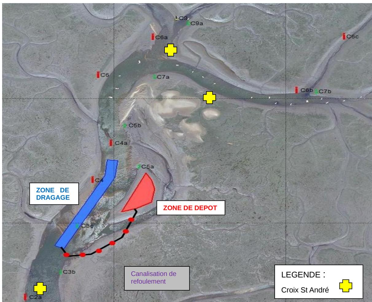
Les sédiments seront déposés sur le petit îlot, au sud de la balise C5a, sur une surface de 6 700 m<sup>2</sup>.
