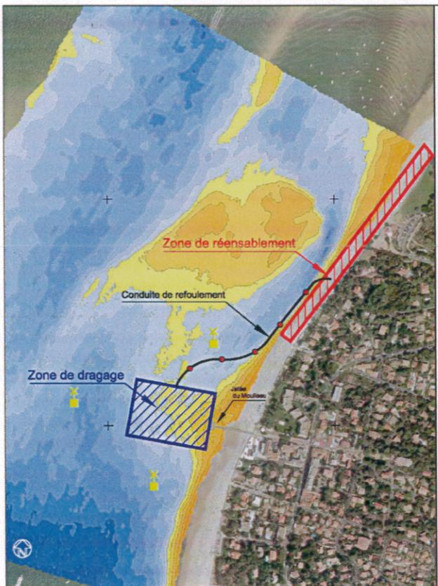
L'installation sera balisée par 3 croix de St André situées de part et d'autre de la drague : au nord et au sud et une à l'ouest. Celles-ci seront déplacées au fur et à mesure de l'avancement du chantier. La conduite de refoulement sera signalée par des bouées rouges espacées d'environ 30m.
